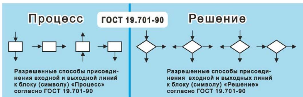
**Рис. 189.** ГОСТ 19.701—90 разрешает присоединять линии к блокам Процесс и Решение четырьмя разными способами, т. е. неоднозначно.
