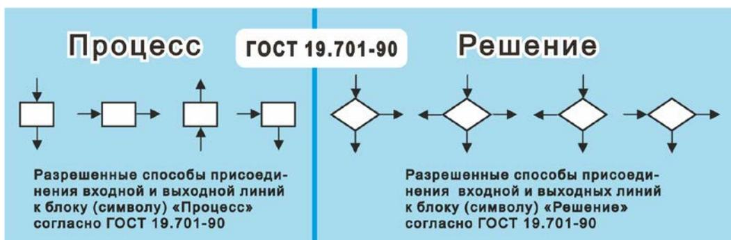
**Рис. 189.** ГОСТ 19.701—90 разрешает присоединять линии к блокам Процесс и Решение четырьмя разными способами, т. е. неоднозначно.
