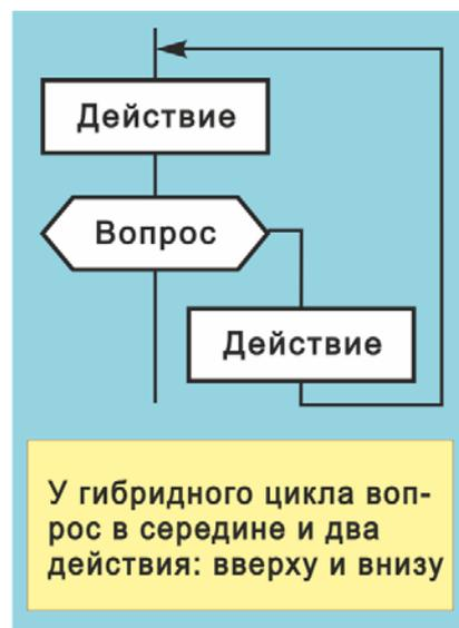
Рис. 45. Гибридный цикл
