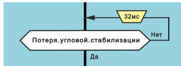
Рис. 118. Цикл ЖДАТЬ. Строгая запись используемая в алгоритме
