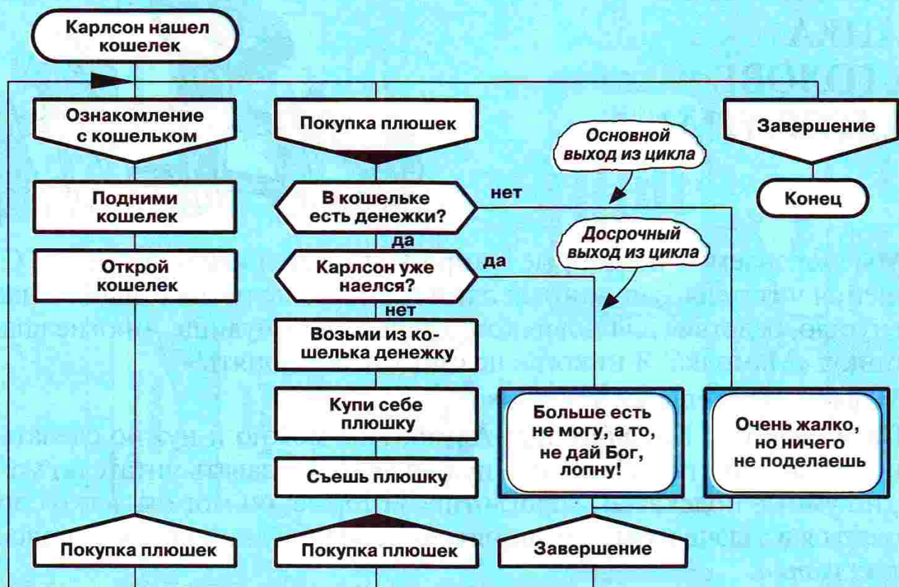
Рис. 86. Веточный цикл с досрочным выходом. Сравни с рис. 72
