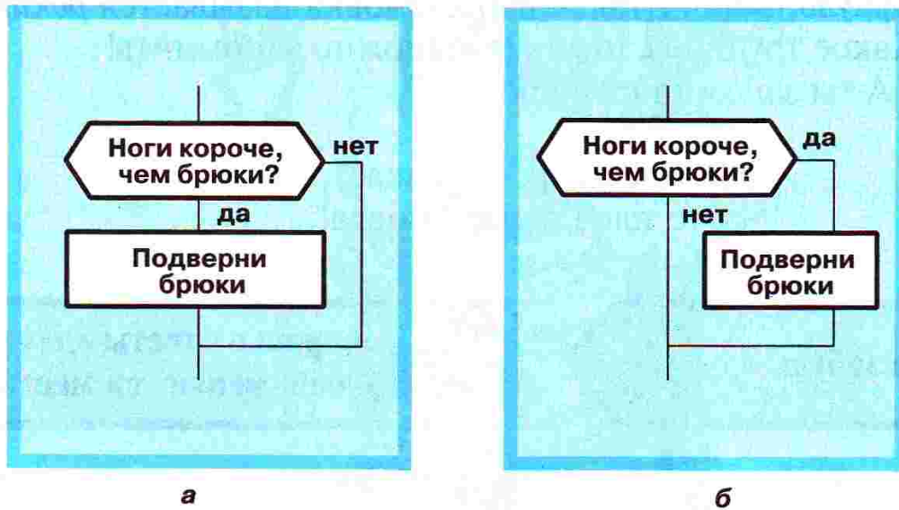
Рис. 34. Пример равносильных алгоритмов
