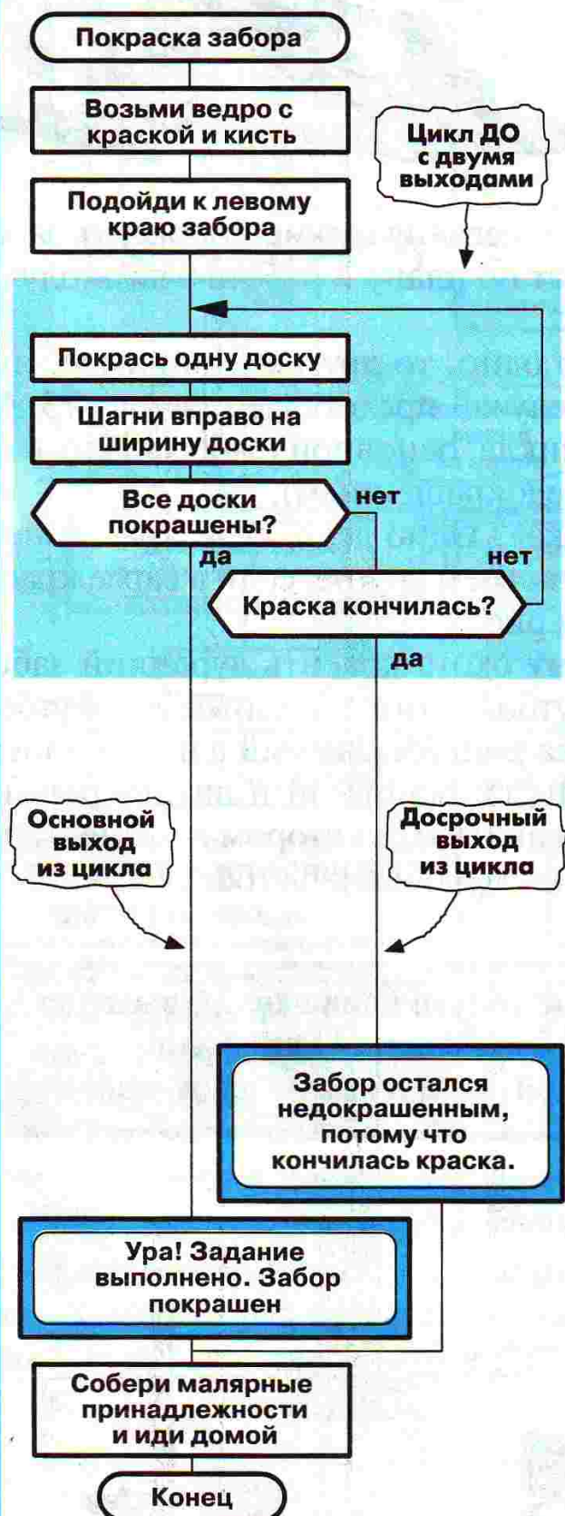
Рис. 73. Досрочный выход из цикла, потому что кончилась краска
