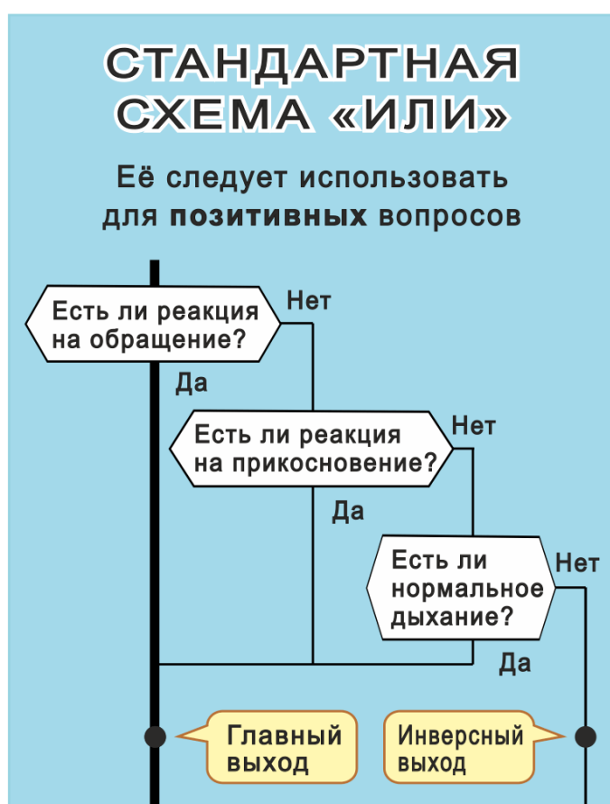
Рис. 2. Стандартная схема ИЛИ с тремя позитивными вопросами. Главный выход (через «Да») слева
