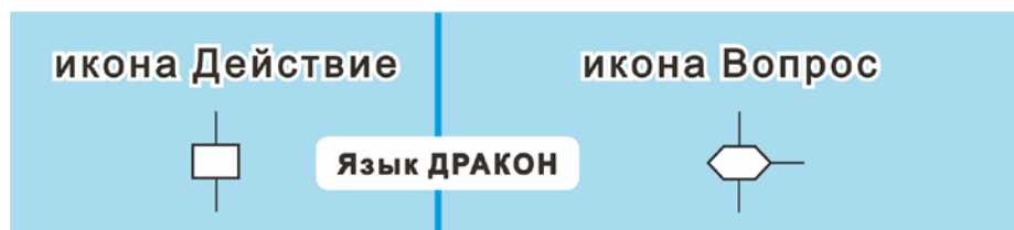
Рис. 27. Язык ДРАКОН предлагает однозначный (единственный) вариант присоединения отростков к иконам. Икона Действие имеет два отростка: входной (сверху) и выходной (снизу). Икона Вопрос имеет три отростка: входной (сверху) и два выходных (внизу и справа).
