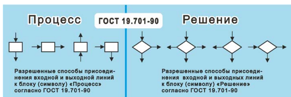
Рис. 28. ГОСТ 19.701-90 разрешает присоединять линии к блокам Процесс и Решение четырьмя разными способами, т. е. неоднозначно. Язык ДРАКОН устраняет недостаток и предлагает однозначный (единственный) вариант
