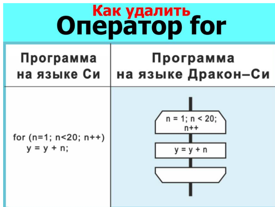
Рис. 13. Текстовый оператор for можно удалить и заменить на управляющую графику
