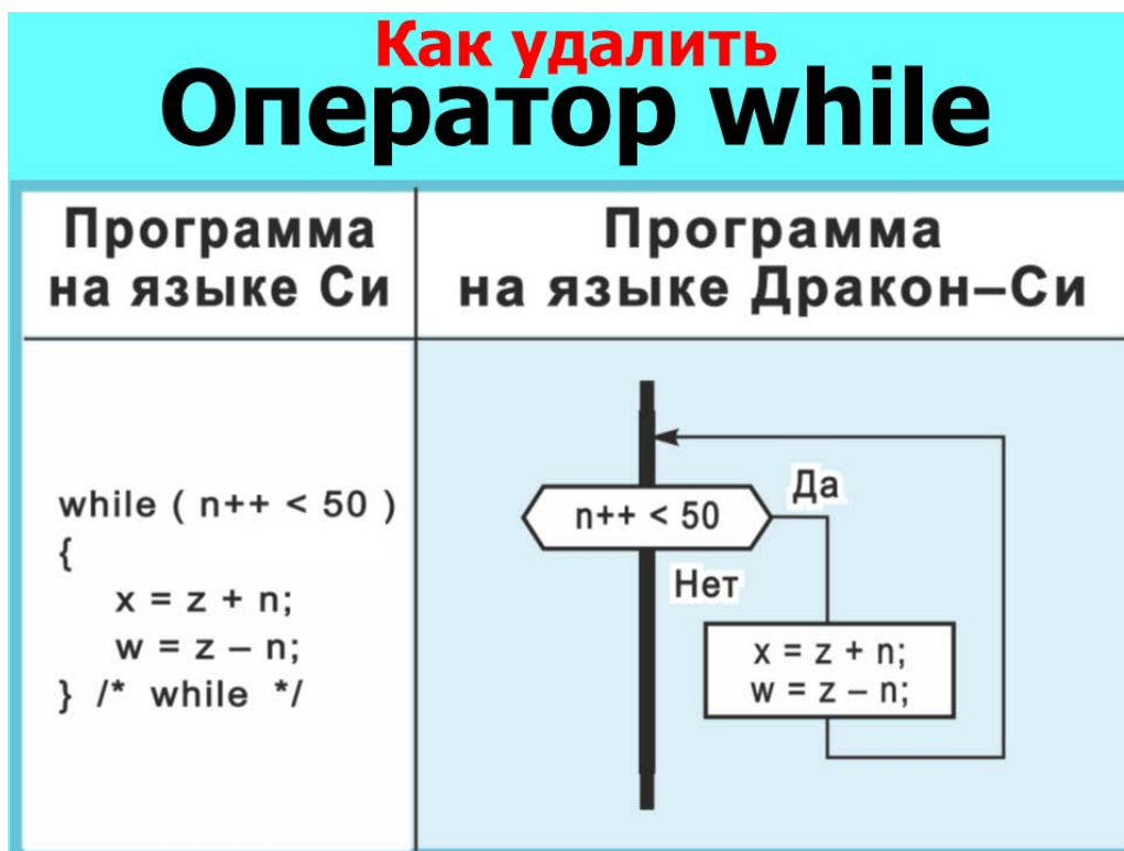
Рис. 11. Текстовый оператор while можно удалить и заменить на управляющую графику ДРАКОНа
